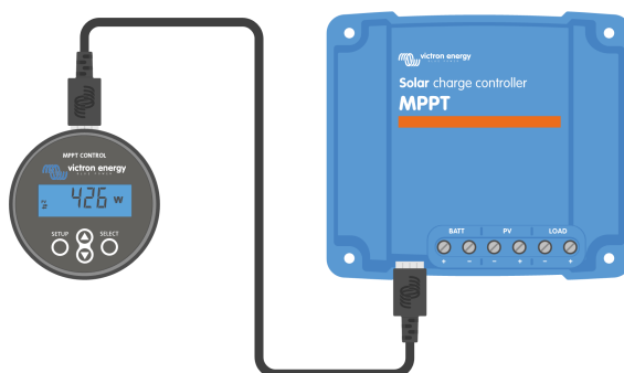
Conecte la pantalla al cargador solar con el cable VE.Direct.
